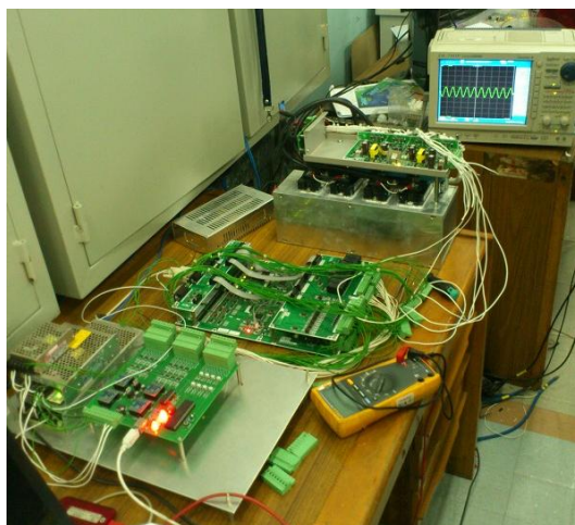
Gambar 10. Pengetesan fungsi modul inverter
